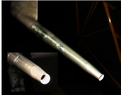
**Abbildung** Prandtl-Staurohr einer F/A-18. ([Link](#))
