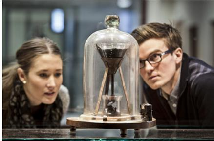
**Abbildung** Das berühmte “Pitch Drop Experiment”
