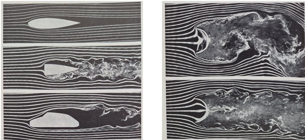
**Abbildung** Nichtstationäre Strömungen im Rauchkanal (Schreiner, Seite 218) bei verschiedenen Hindernissen.
